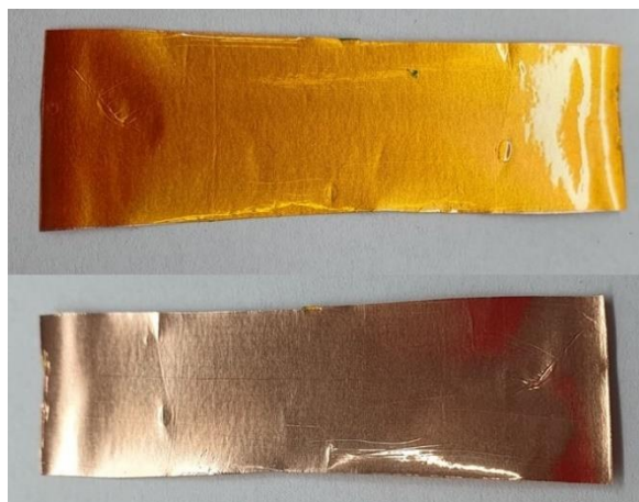
Figura B.2 - Imagem de um substrato com fita kapton e cobre.
