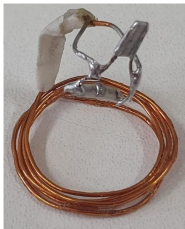
Figura 5.2 - Bobina repetidora do sistema proposto.
