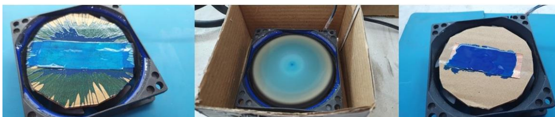
Figura B.3 - Substrato antes, durante e depois da centrifugação.
