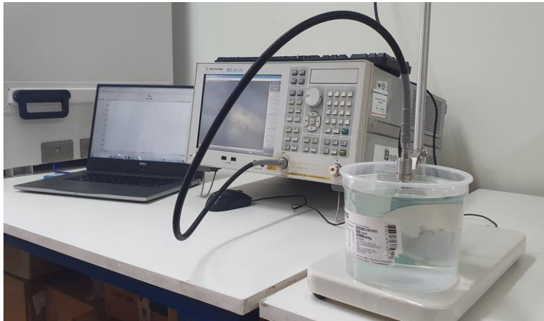
Figura 4.6 - Processo de medida da solução aquosa de cloreto de sódio.
