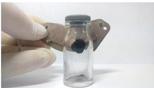
**Figura 17** - CAM suspenso por um ímã.
