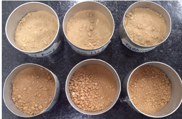
Figura 3.10 - Amostras de solos utilizadas para a determinação do teor de umidade. As três amostras de cima na imagem pertencem ao ponto P2, enquanto as amostras na parte de baixo pertencem à P1. FONTE: A autora
