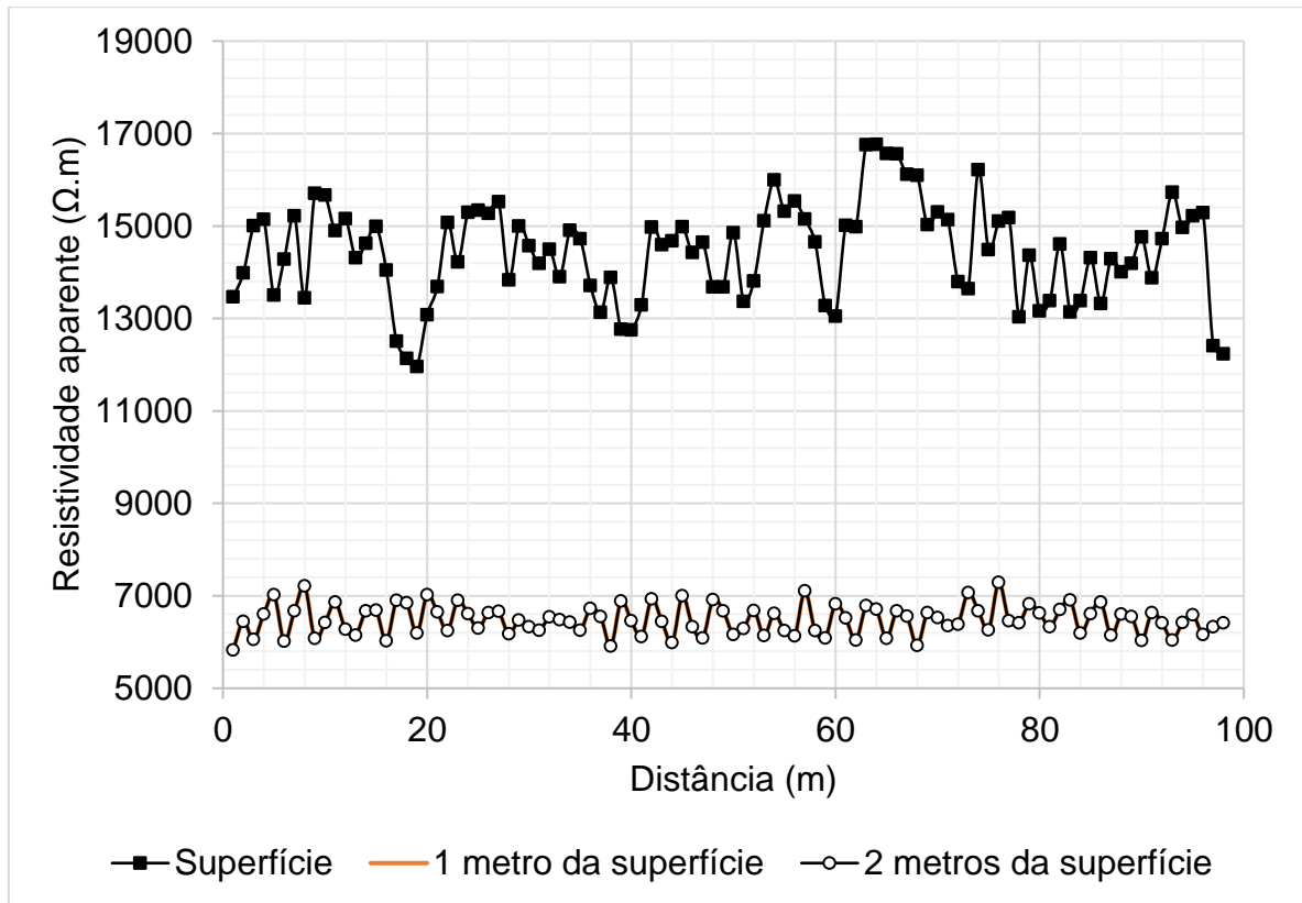
Figura 4.13 Resistividade aparente na superfície, e a 1 e 2 metros de profundidade obtida através da simulação utilizando a malha finer
