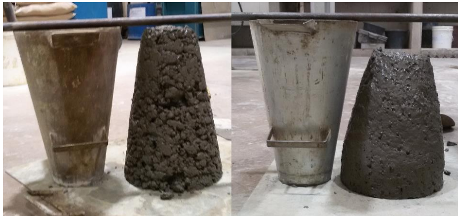
Figura 10: Abatimento do tronco de cone dos traços T10P (esquerda) e T10S (direita).
