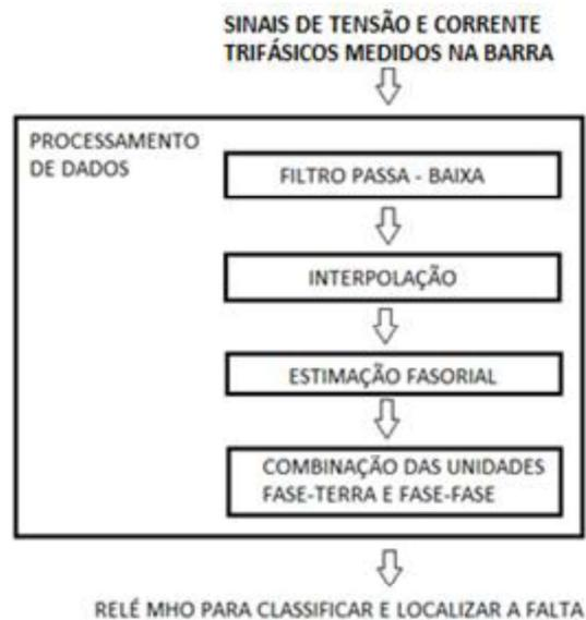
Figura 4.13 – Fluxograma da estrutura do algoritmo de processamento dos dados para o relé de distância.
