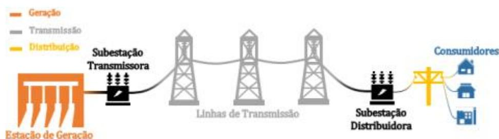
Figura 1.3 – Representação esquemática do SEP (SANTOS, 2017)
