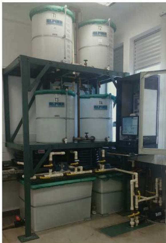
Figura 4.6: Sistema de tanques acoplados.
