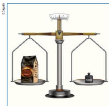
▲ O princípio de medição da massa de um material, em uma **balança**, baseia-se no **equilíbrio entre a massa que se deseja medir e a massa padrão conhecida**. As forças atuantes no sistema da balança se equilibram quando as massas se igualam e os pratos da balança ficam no mesmo nível.
