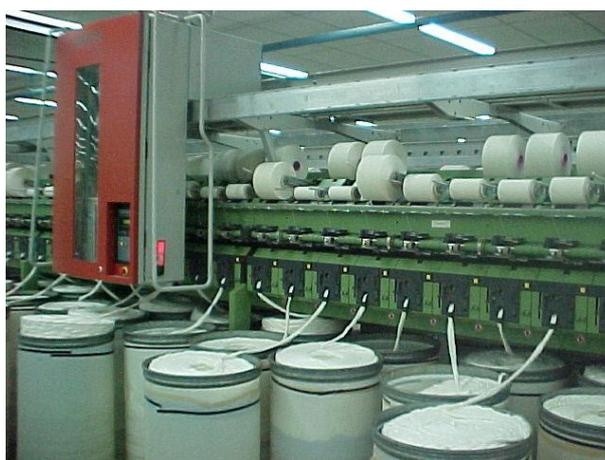
FIGURA 7 - FILATÓRIO *OPEN-END*
