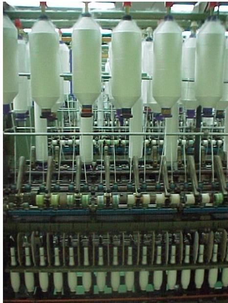
FIGURA 9 - FILATÓRIO DE ANEL
