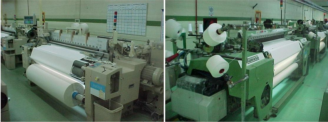
FIGURA 12 - TEAR À PINÇA E TEAR À JATO DE AR
